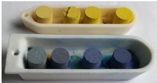
**FIGURE 3.3** – Série  $Mn_xCo_{1-x}Nb_2O_6$  (bleu) et  $Mn_xNi_{1-x}Nb_2O_6$  (jaune).
