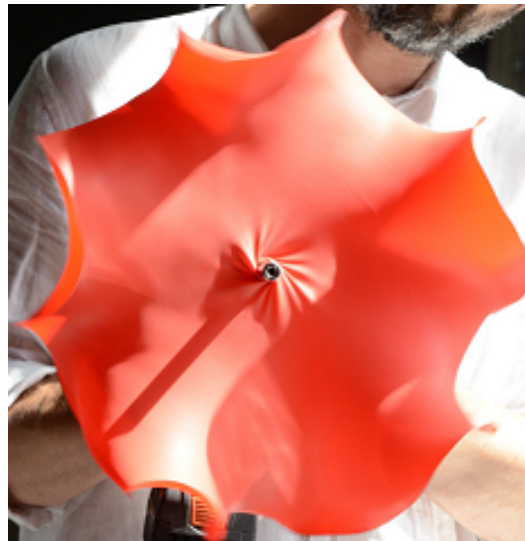
FIG. B.1 Déformation d'un grand disque en latex en rotation rapide. La structure hors du plan présente une symétrie de rotation d'ordre 5.
