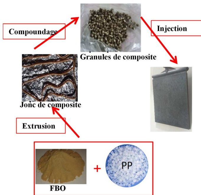
Figure II.8 : Matières premières et étapes de fabrication du composite PP/FBO.
