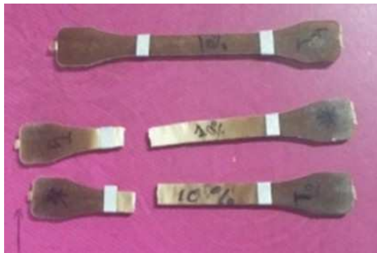
Figure III.7 : Epreuves PP/FBO avec m_{FBO} = 10\% avant et après l'essai de traction.
