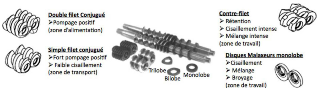
Figure II.6 : Formes des vis dans les extrudeuses bi-vis [6, 8].
