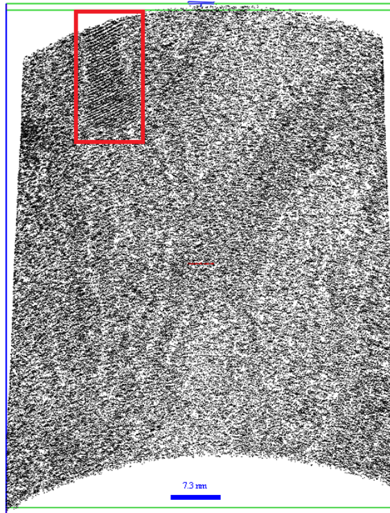
FIGURE 4.7 – Coupe transversale dans le volume reconstruit de FeSiB recuit à 500^{\circ}\text{C} pendant 1h . Des plans sont visibles selon certaines orientations du volume dans certaines phases de la reconstruction (encadré en rouge).
