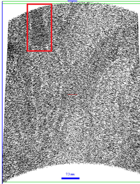
FIGURE 4.7 – Coupe transversale dans le volume reconstruit de FeSiB recuit à 500^{\circ}\text{C} pendant 1h . Des plans sont visibles selon certaines orientations du volume dans certaines phases de la reconstruction (encadré en rouge).
