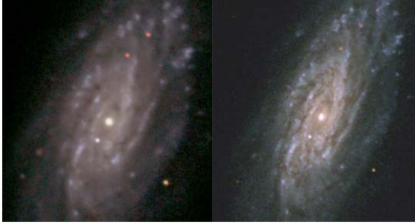
FIGURE 1.11: Images de la galaxie HCG87c prises avec Gemini South sans son optique adaptative (gauche) et avec le télescope spatial Hubble (droite). Gemini ne peut résoudre les détails, lissés par la PSF longue pose. Le seeing est d'environ 0.5'' . Les images font 20'' de côté. Crédit Gemini Observatory/-NASA.
