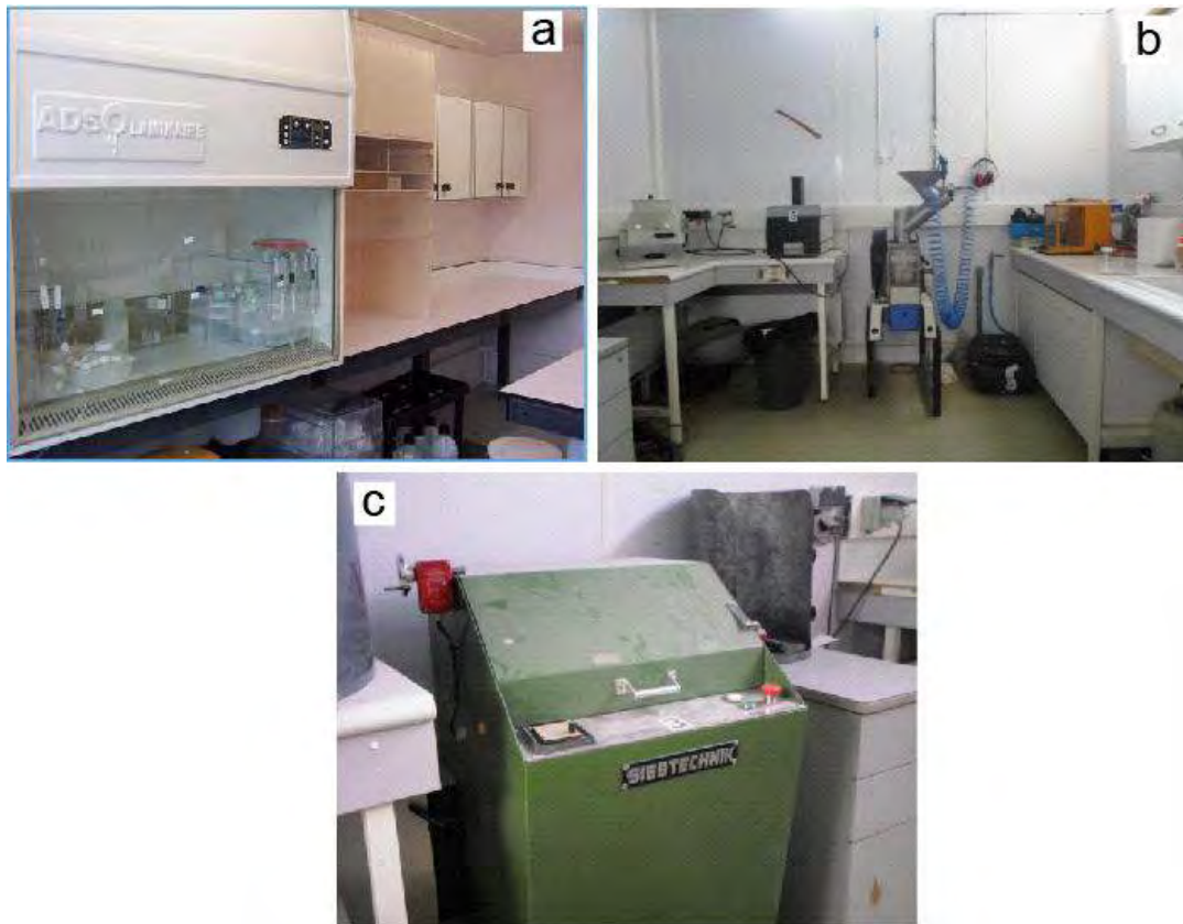
Figure 11 : (a) Hotte à flux laminaire vertical de la salle blanche; (b) concasseur et (c) broyeur.
