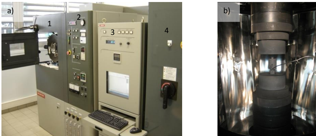
Figure 2-2 : Equipement SPS comprenant a) 1 : l'enceinte de frittage, 2 : l'unité de pilotage de la pompe à vide, 3 : l'unité de pilotage de la presse hydraulique, 4 : l'unité de pilotage du générateur de courant et b) vue de l'intérieur de l'enceinte de frittage.
