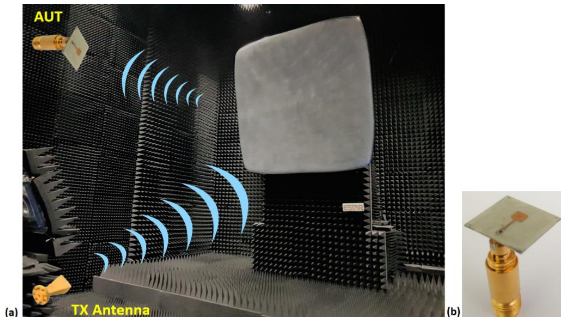
Figure 104 : (a) Base compacte millimétrique pour les mesures de (b) l'antenne fabriquée (AUT).
