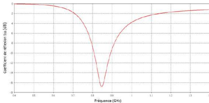
(b) Le coefficient de réflexion  $S_{11}$  du dipôle.
