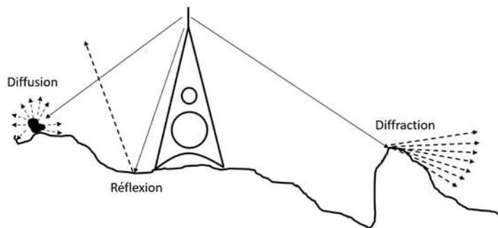
FIGURE I.2. – Trois phénomènes de propagation : Réflexion, Diffusion, Diffraction [1].
