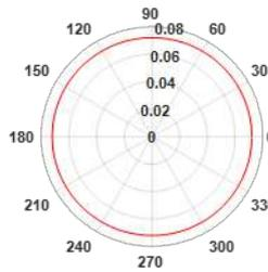
(c) La composante horizontale du champ de la petite boucle sur le plan azimut.
