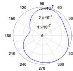
(d) La composante verticale du champ de la petite boucle sur le plan azimut.
