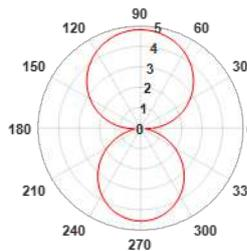
(e) La composante horizontale du champ de la grande boucle sur le plan azimut.
