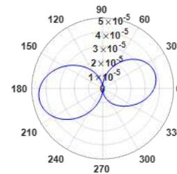
(f) La composante verticale du champ de la grande boucle sur le plan azimut.
