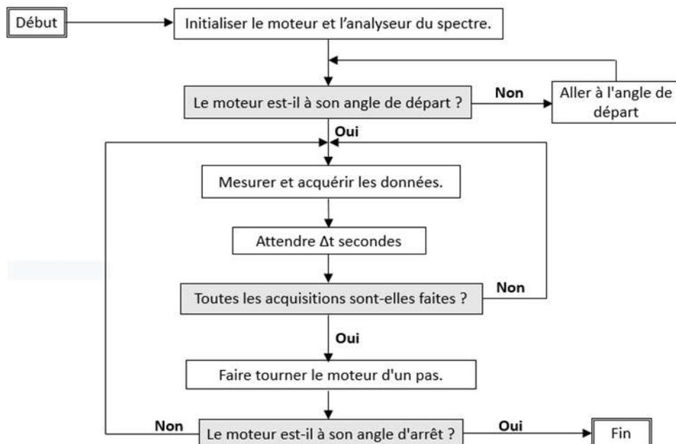
FIGURE I.9. – Algorithme de mesure de canal de propagation.
