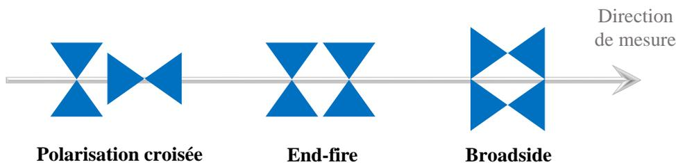
FIGURE 1.19 – Les différentes orientations des antennes GPR.
