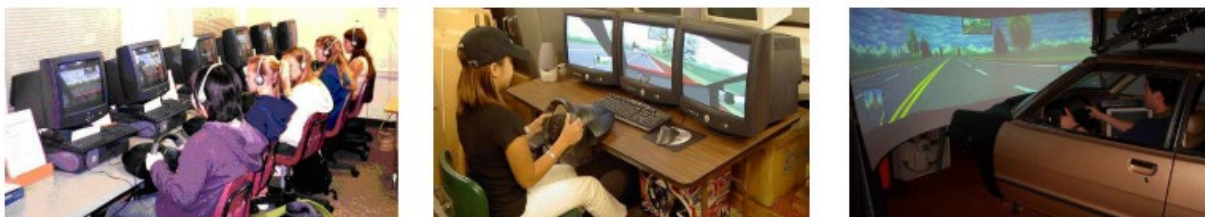
Figure 15, dispositif utilisé par Allen et al., (2010). De gauche à droite, simulateur mono-écran, 3 écrans, pleine échelle
