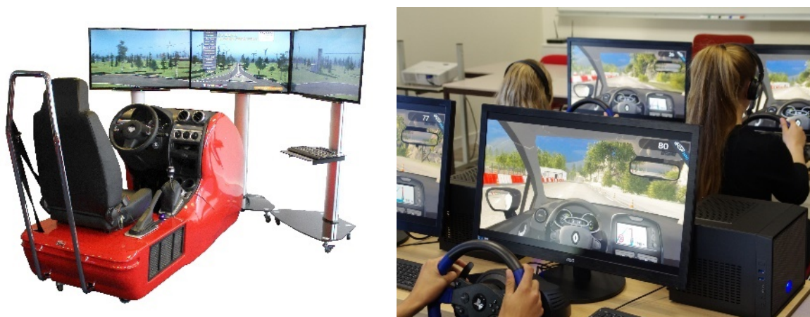
Figure 10, A gauche un simulateur moyenne immersion à 3 écrans de la société DEVELTER © (crédit : http://www.develter.com/simulateurs-conduite-1_FR_r_40.html ) ; à droite un simulateur basse immersion mono-écran (crédit : https://www.lyonmag.com et The Good Drive ©)
