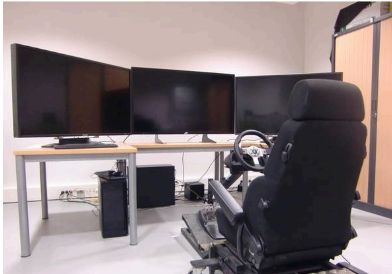
Figure 44, photographie du simulateur à base fixe HDR utilisé pour l'expérimentation
