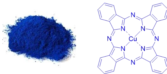
Figure 1-36 : représentation du Monastal blue : phtalocyanine de cuivre utilisée pour les colorants
