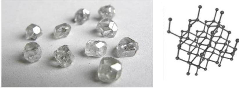
Figure 1-2 : Photo (à gauche) et structure (à droite) du diamant
