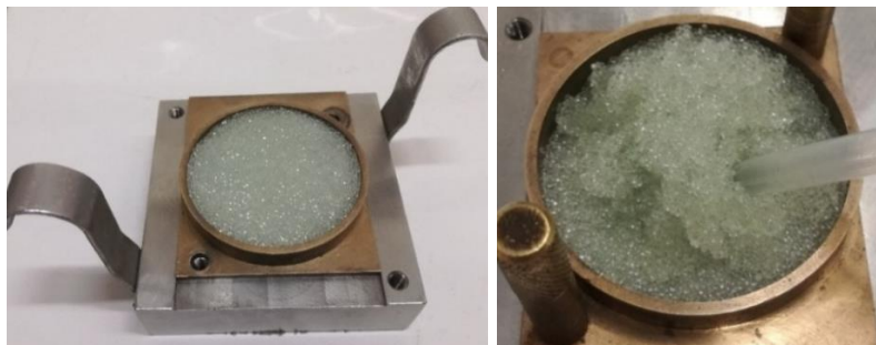
Figure 5.11 - Photos de préparation de l'échantillon humidifié
