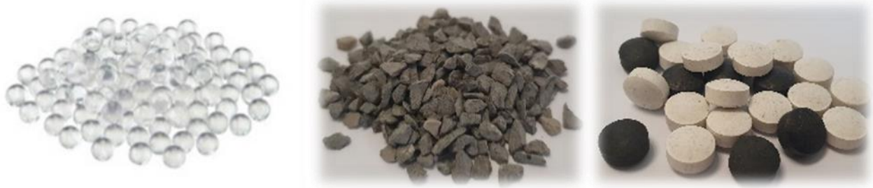
Figure 2.2 - Photo des matériaux utilisés dans cette étude (B* Bille de verre, S* Sable concassé, C*Comprimé pharmaceutique)
