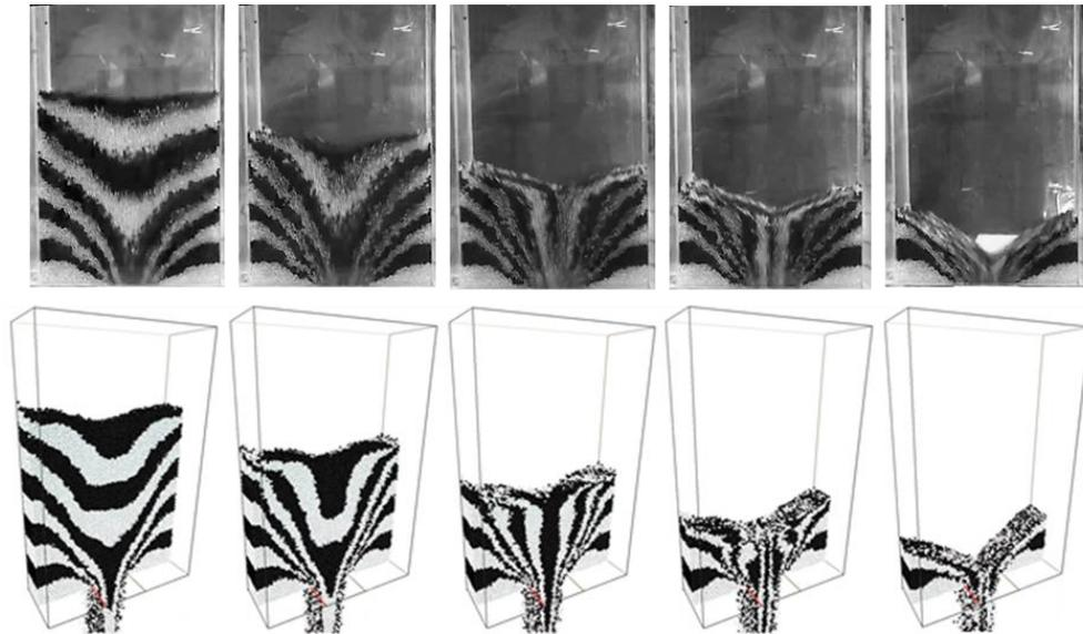
Figure 4.26 - Comparaison expérimentales et de simulations numériques correspondantes de l'écoulement des billes de verre de 2 mm dans un silo fond plat à plusieurs instance de décharge
