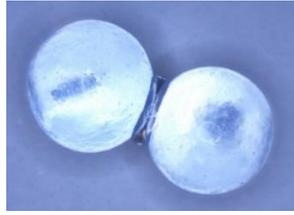
*Figure 5.10 - Observation au microscope d'un pont capillaire*
