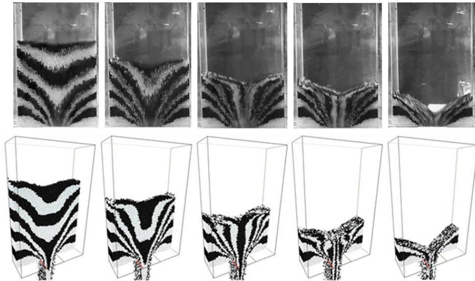
Figure 4.26 - Comparaison expérimentales et de simulations numériques correspondantes de l'écoulement des billes de verre de 2 mm dans un silo fond plat à plusieurs instance de décharge
