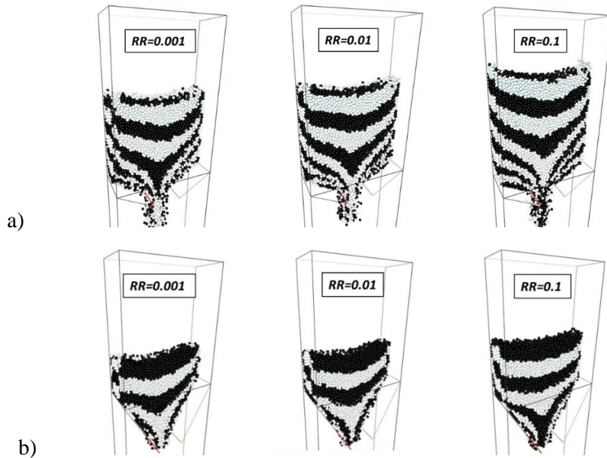
Figure 4.21 - Ecoulement des billes 4 mm à t = 0,8s pour différentes valeurs de coefficient de résistance au roulement dans un silo à trémie a) 30^\circ et b) 60^\circ
