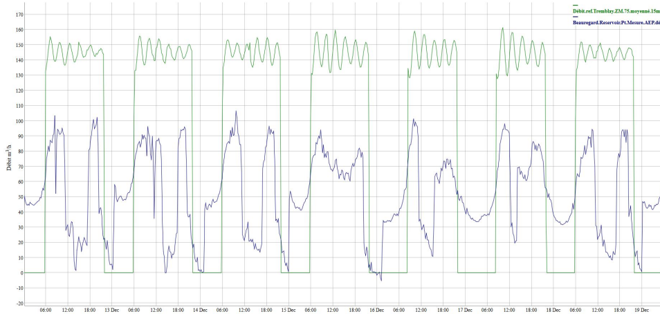
FIGURE 1.9 – Courbe de débits en \text{m}^3/\text{h} sur une semaine pour un réservoir (en violet) et une usine de production (en vert)
