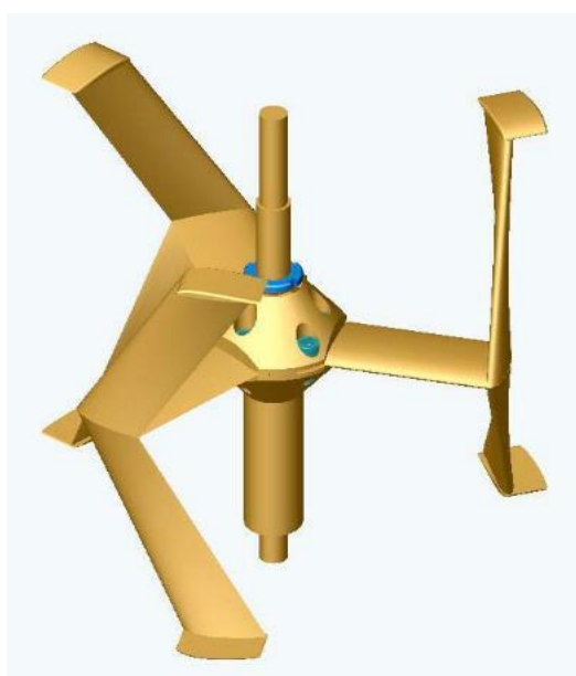
Figure 1.10. Turbine à axe vertical libre. Projet Harvest [22].
