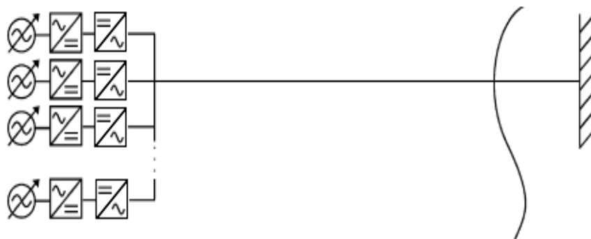
Figure 1.33. Illustration de la topologie de connexion n°2 avec un système de collection et de transmission en AC.
