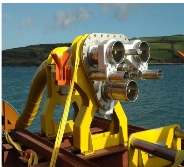
Figure 1.19. Connecteur à contact humide (Wet mate)
