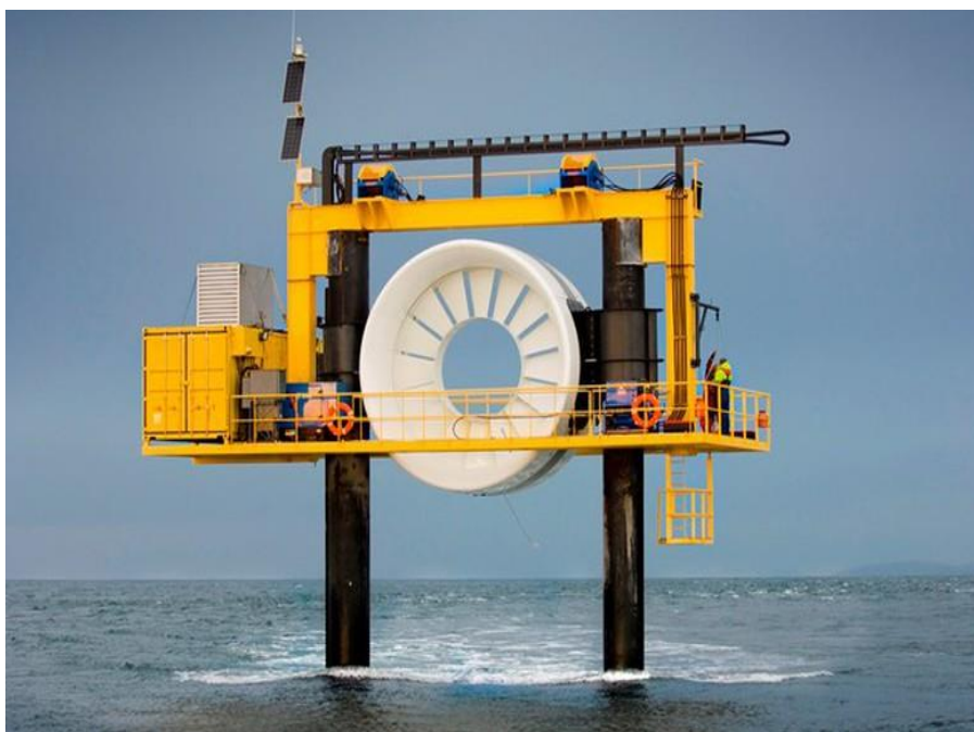
Figure 1.9. Modèle réduit d'hydrolienne de technologie OpenHydro sur un site de test [Source : OpenHydro].
