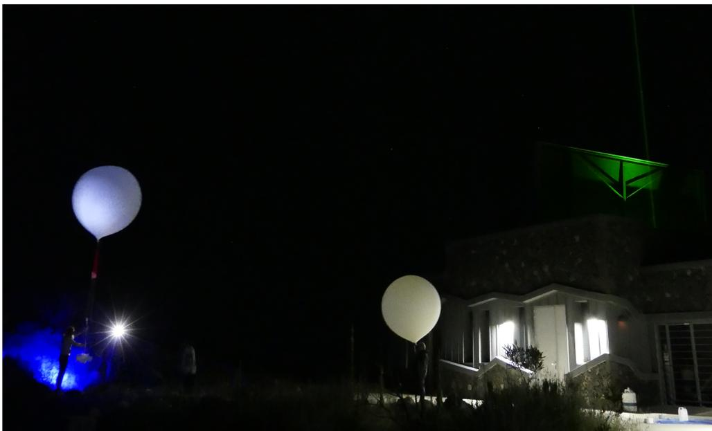
FIGURE 2.5 – Lâcher du sondage LM022 avec deux ballons. En vert à droite le Lidar Raman H<sub>2</sub>O en fonctionnement, en bleu la lumière de la sonde COBALD. Source : Susanne Koerner
