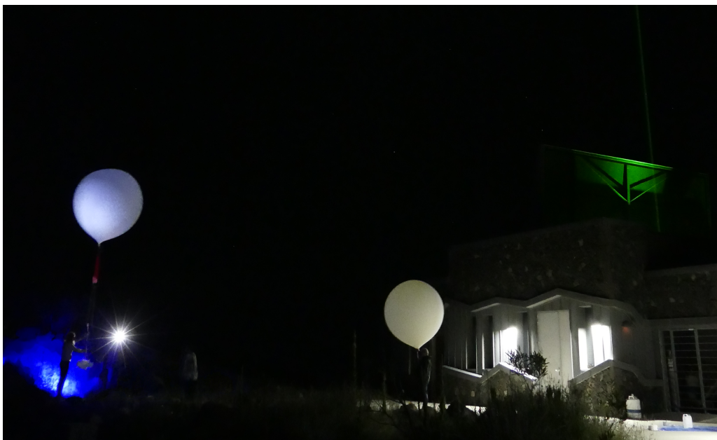
FIGURE 2.5 – Lâcher du sondage LM022 avec deux ballons. En vert à droite le Lidar Raman H_2O en fonctionnement, en bleu la lumière de la sonde COBALD. Source : Susanne Koerner
