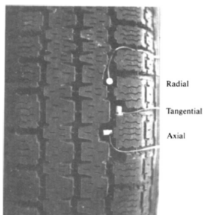
Figure 1.12 – Accéléromètres insérés dans la bande de roulement selon les directions axiale, radiale et tangentielle (Jennewein et Bergmann, 1985).
