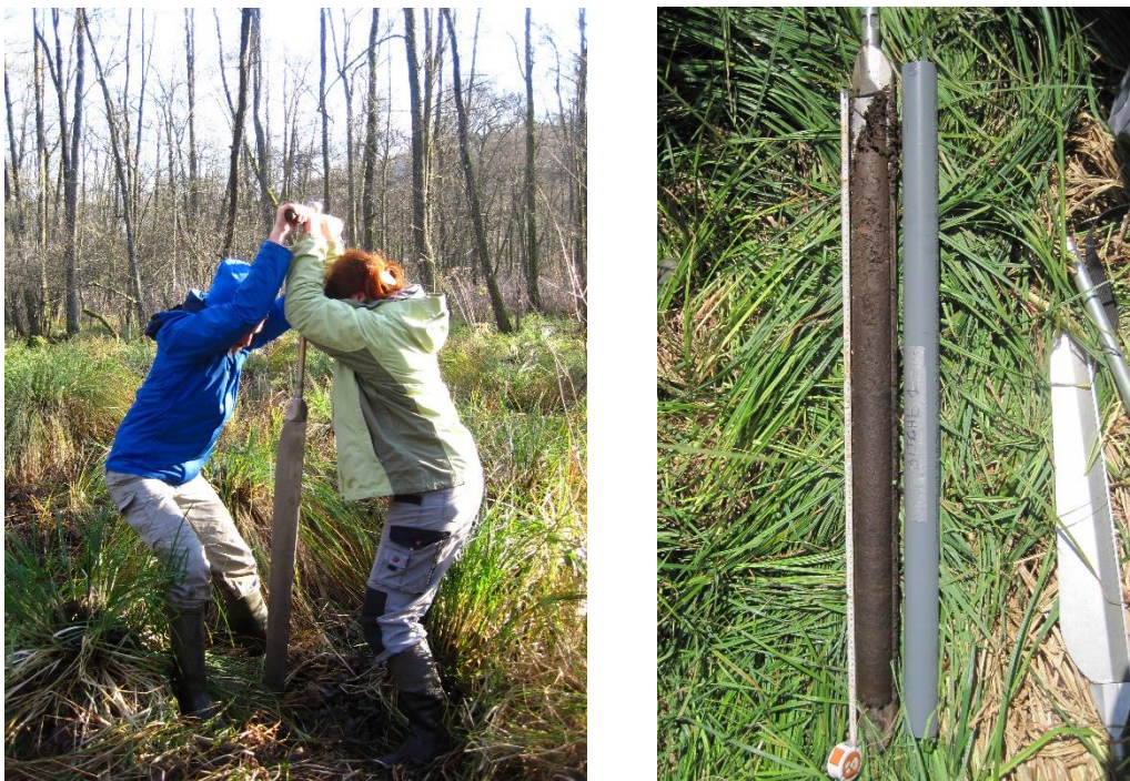
Figure II.1-1 : Photo d'un carottage au carottier russe et photo d'un sondage dans le carottier (cliché : E.Gouriveau)
