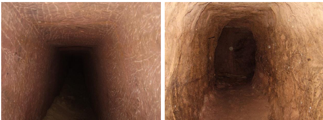
Figure I.2-24 : Galerie d'extraction du minerai de fer dans le Pays de Bitche (cliché : S. Schmit)
