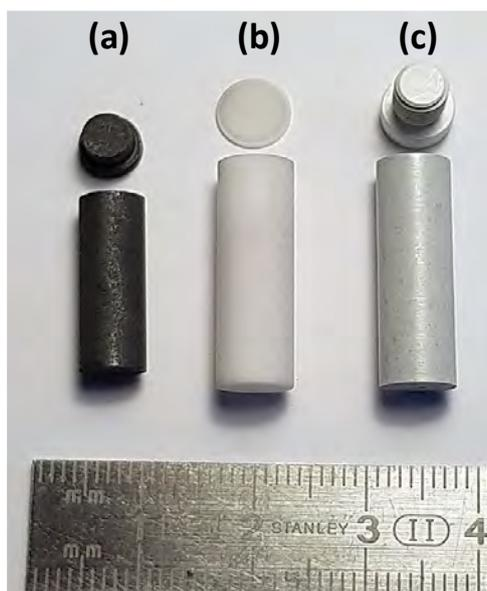
**Figure II-7 : Photo des différents types de creuset DSC ; creuset graphite (a), creuset de garde  $\text{Al}_2\text{O}_3$  (b), creuset nitrure de bore (c)**
