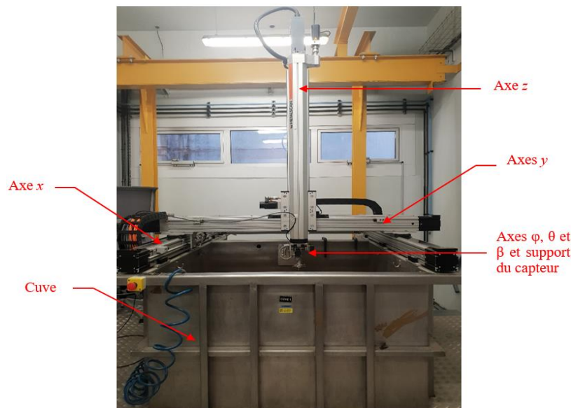
Figure II-31 : Vue d'ensemble de dispositif expérimental de mesure ultrasonore en mode émission-réflexion (BACUS) du laboratoire CND d'EDF R&D.
