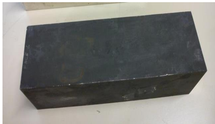
Figure II-1 : Bloc (B359) prélevé dans une barre forgée en Inconel600.
