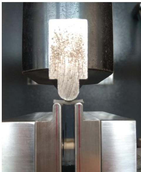
Figure 3.12 Essais de flexion 3 points entre appuis rapprochés
