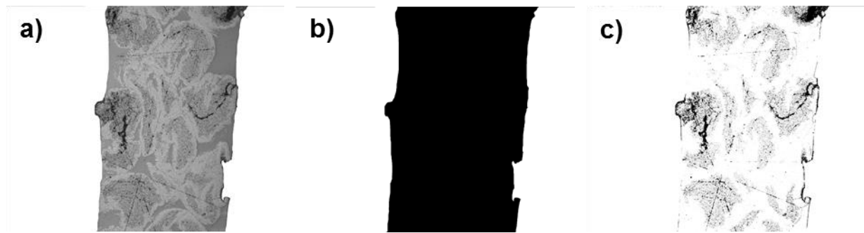
Figure 2.52 Méthode utilisée pour le calcul des taux de porosité X_v
