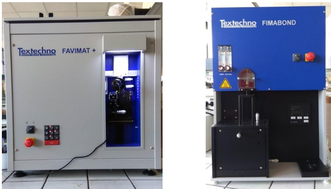
Figure 3.1 Equipement utilisé pour la réalisation des essais de pull-out : FAVIMAT+ (à gauche) et FIMABOND (à droite)
