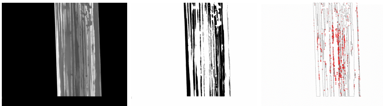
Figure 2.13 Traitement des images avec ImageJ® : a) mesure de la surface de la fibre b) seuillage (threshold) c) mesure de la surface sèche
