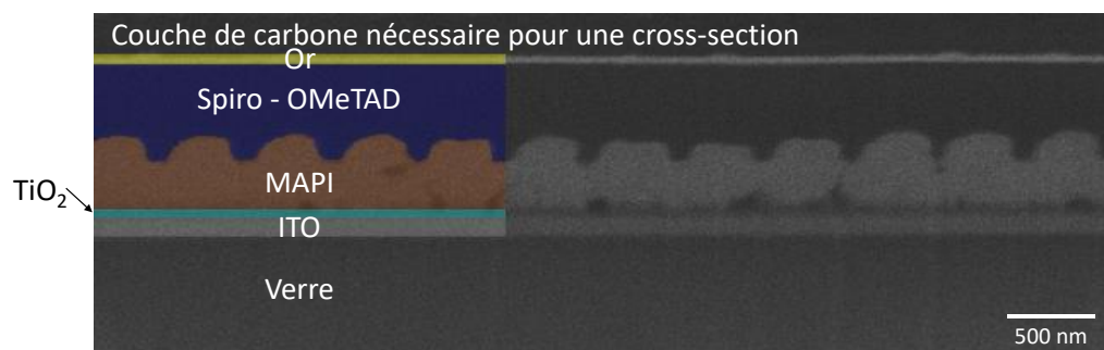
Figure 119. Image FIB, en partie colorisée numériquement, d'une cross-section d'une cellule pérovskite avec structure
