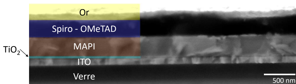
Figure 109. Image MEB, en partie colorisé numériquement, d'une cellule pérovskite vue en coupe
