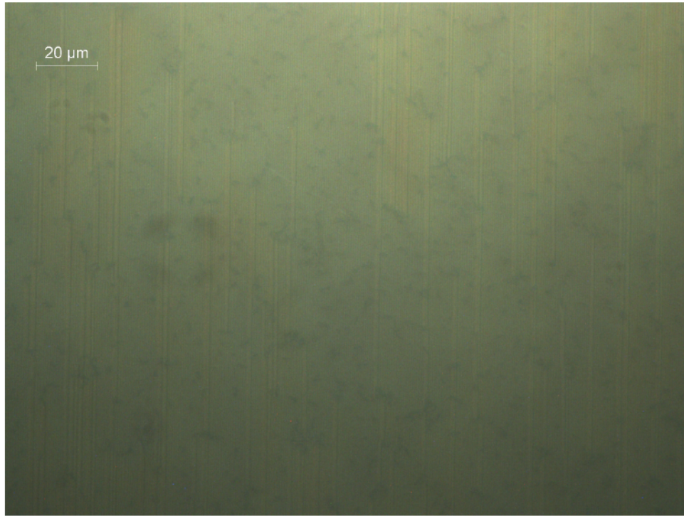
FIGURE 5.23: Image de microscopie optique en analyseur/polariseur croisés d'un échantillon récent de nanoparticules de 7 nm de diamètre dans les stries huileuses
