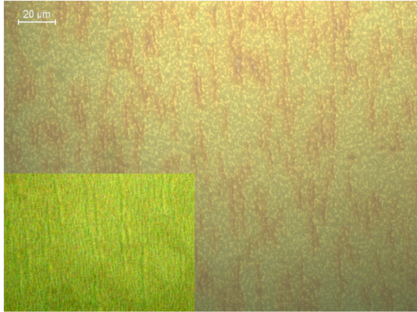
FIGURE 4.5: Images de microscopie optique d'un échantillon (2nd type) de stries huileuses en présence de nanoparticules en analyseur/polariseur parallèle et croisé (inset)
