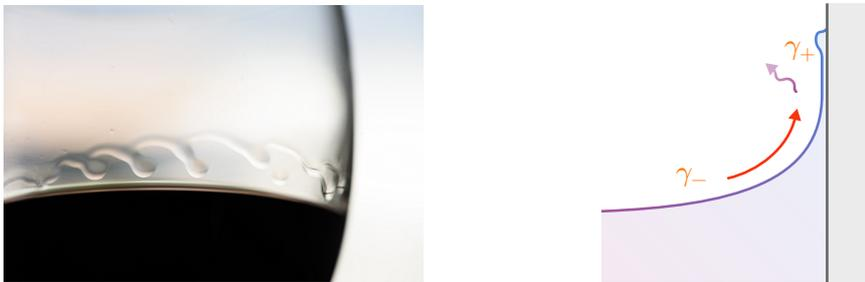
**a** Dans un verre d'alcool suffisamment alcoolisé, des gouttes apparaissent et glissent le long du verre.
