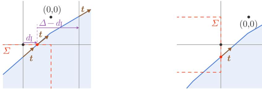
**a** Calcul de la composante  $\sigma_{\gamma,xy}$  du tenseur des contraintes. La tangente est évaluée au point d'intersection de l'interface avec la face de la surface de contrôle en interpolant linéairement les tangentes calculées sur les faces à gauche et à droite.
