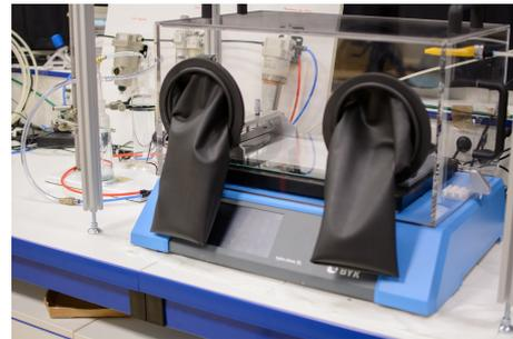
**b** Enceinte à contrôle d'humidité.
