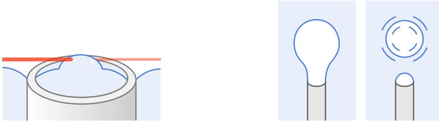
**a** Lorsqu'une bulle est au sommet du bain, elle atténue le signal reçu par le capteur placé en face du laser. La bulle est piégée au centre d'un anneau de téflon de sorte qu'elle ne dérive pas et qu'elle reste dans l'alignement du laser et du capteur.
