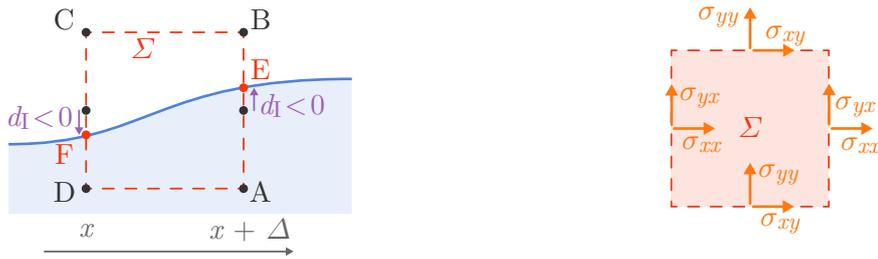
**a** Schéma d'une surface de contrôle  $\Sigma$  dont les faces gauche et droite sont intersectées par une interface, respectivement en F et E. La distance  $d_I$  quantifie la distance algébrique entre le centre de la face et le point d'intersection de l'interface avec cette face.
