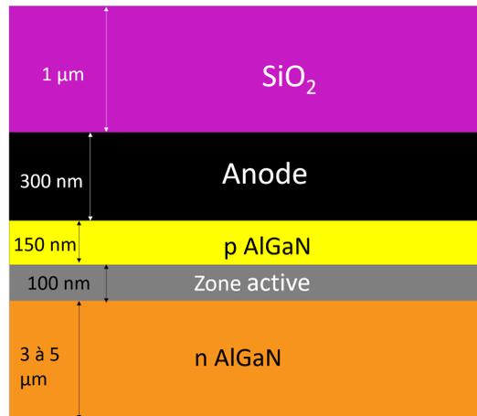
FIGURE I.45 – Structure de DEL-UV standard après dépôt de métal et dépôt de  $SiO_2$ .
