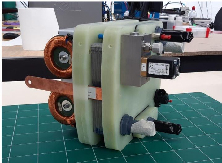
**Figure 5 15. Photo du stack du projet COMEHTE avec 20 cellules de 170 cm<sup>2</sup> des AMEs Aquivion® 830 EW + 15 % nanofibres PBI/ 6%<sub>m</sub> CeO<sub>2</sub>@HNt-NH<sub>2</sub>**
