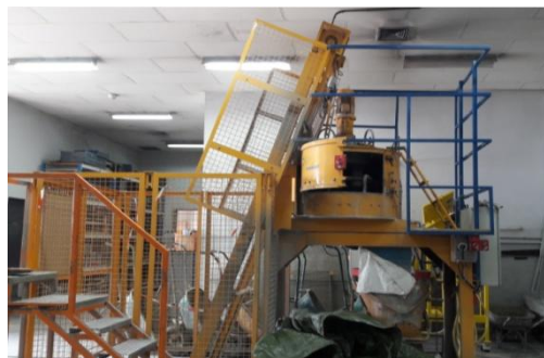
Figure II-1 : Malaxeur de 150L utilisé pour la fabrication des bétons
