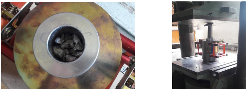
Figure II-11 : Système d'extraction de la solution interstitielle
