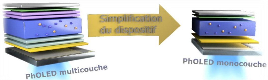
Figure 2 Représentation schématique de la simplification d'un dispositif PhOLED multicouche en un dispositif PhOLED monocouche.
