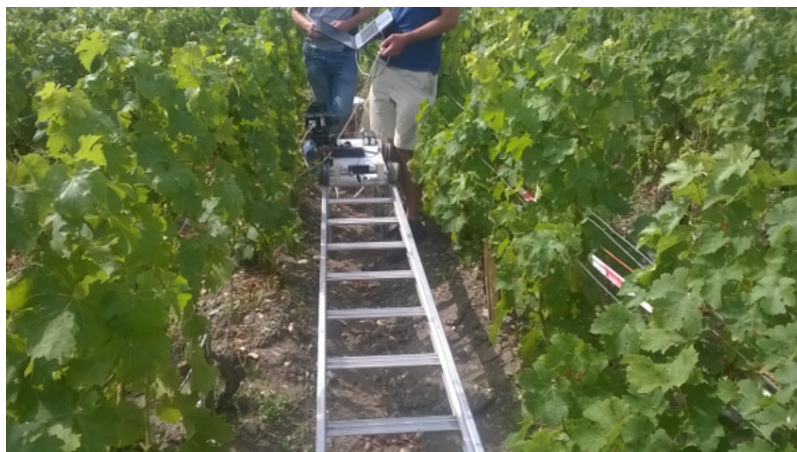
Figure 7.3 – Photo du dispositif d'acquisition hyperspectral progressant dans un inter-rang. Le chariot avance sur l'échelle à vitesse constante et la caméra couvre plusieurs pieds de vigne.
