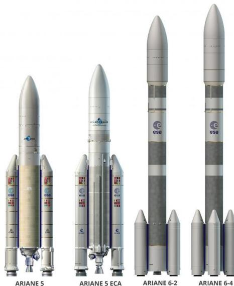
FIGURE A.54 – Comparaison des architectures d'Ariane 5 et d'Ariane 6
