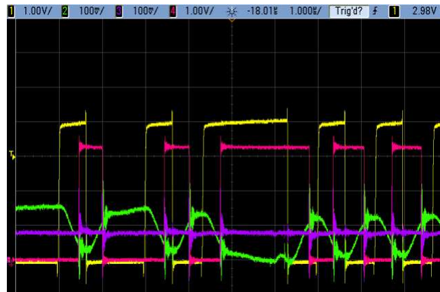
Figure 12 : Capture d'écran de l'oscilloscope, montrant la transmission d'une série de bits à un débit de 2 MBd et les paramètres mentionnés dans le tableau en dessus de la figure.
