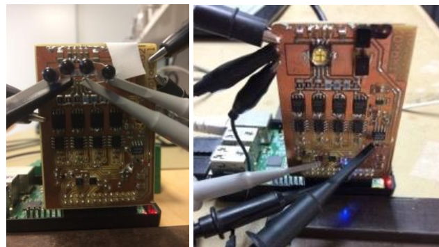
Figure 11 : Carte émettrice (à gauche) et réceptrice (à droite). Les DEL entourées d'une lentille sphérique sur la carte Rx ne sont pas utilisées et pourraient être remplacées par des DEL IR comme sur la carte Tx pour des tests bidirectionnels.
