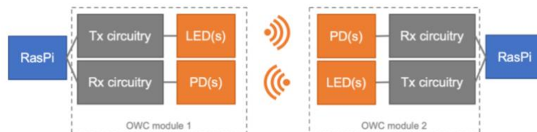
Figure 10 : Vue d'ensemble des modules de transmission optique sans fil
