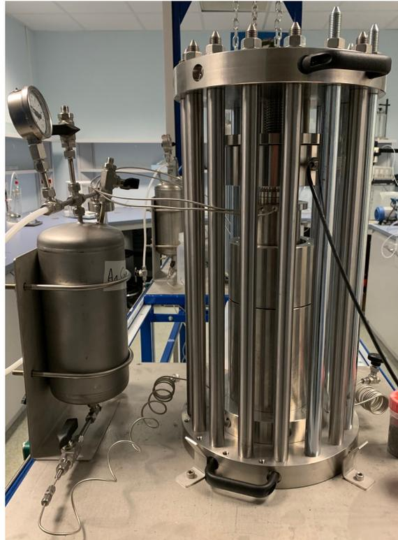
FIGURE II.70 – Photographie du dispositif de mesure des pressions de gonflement
