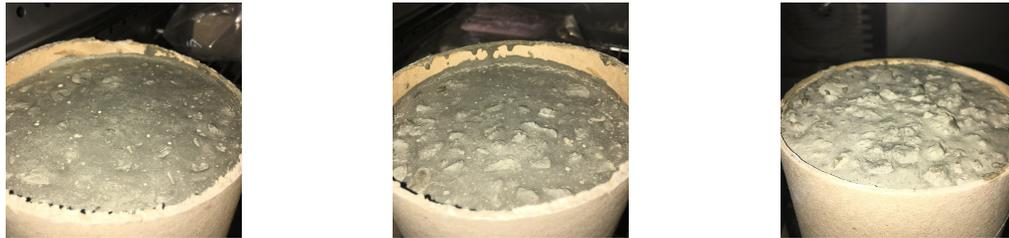
(a) Éprouvette 110 × 50 mm      (b) Éprouvette 110 × 110 mm      (c) Éprouvette 110 × 220 mm
