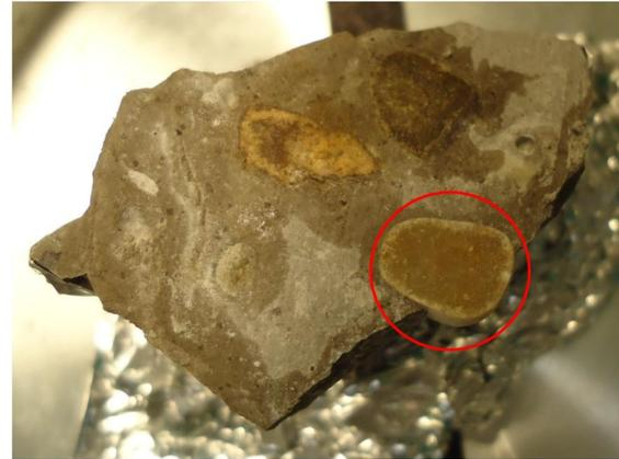
(b) Détail d'un granulats altéré, montrant une décoloration en sa périphérie
