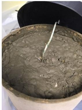
FIGURE II.9 – Éprouvette de béton  $110 \times 220$  mm après gâchée et avant application du cycle thermique
