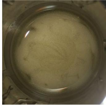
FIGURE III.26 – Photographie du gel complet contenant 38 %H<sub>2</sub>O avec inclusion de bulles d'air suite à l'essai d'écoulement
