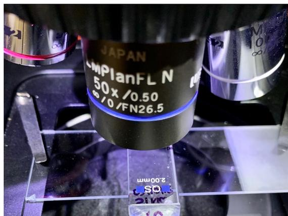
FIGURE B.15 – Montage utilisé pour l'analyse des gels par spectroscopie Raman
