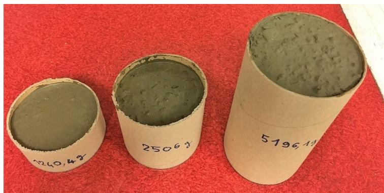
FIGURE II.30 – Éprouvettes 110 × 50 mm, 110 × 110 mm et 110 × 220 mm après gâchée et avant conservation à 20 °C et environ 90 %HR
