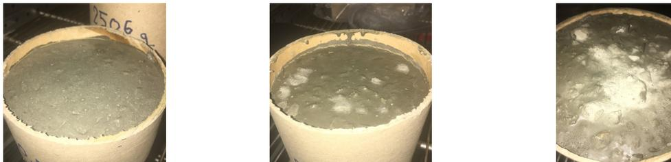
(a) Éprouvette 110 × 50 mm      (b) Éprouvette 110 × 110 mm      (c) Éprouvette 110 × 220 mm
