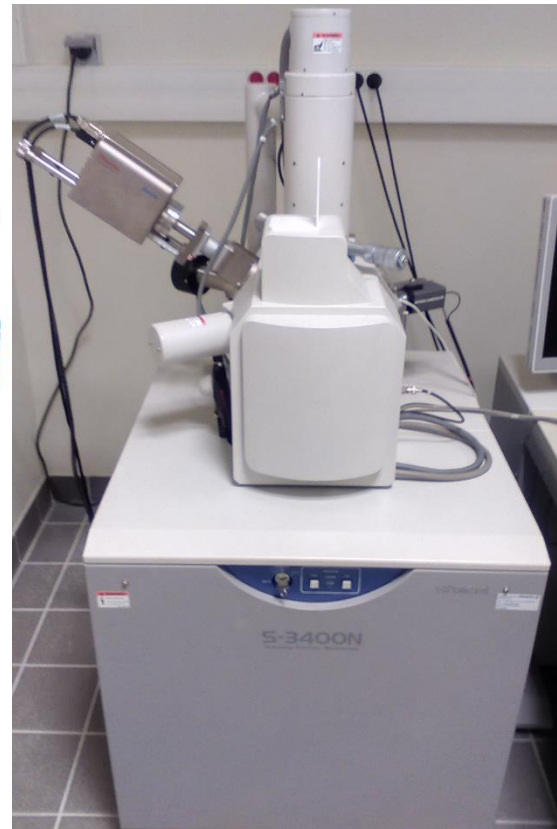
Figure 121 b : MEB Hitachi S-3400N avec analyseur EDS Thermofisher
