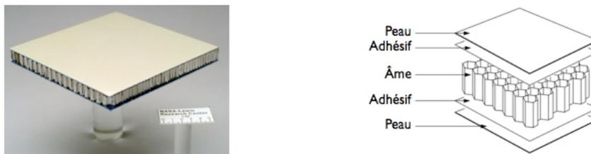
FIGURE 1.18. Une structure en sandwich [13].
