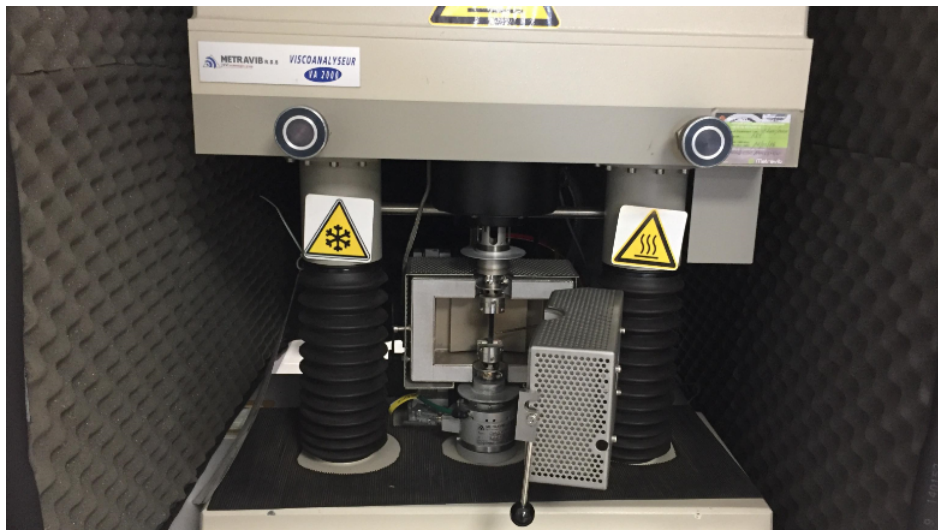
FIGURE 5.15. Banc d'essais de la machine VA2000
