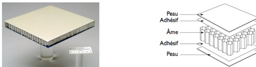
FIGURE 1.18. Une structure en sandwich [13].
