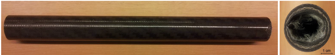
FIGURE 1.20. Segment de bras robotique en composite stratifié hybride [14].
