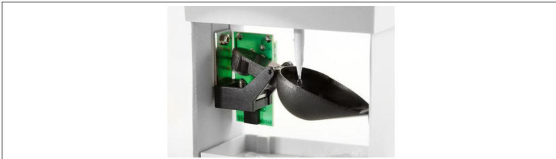
FIGURE 10 – cuillère à bascule servant à la mesure des précipitations (source Argalis)
