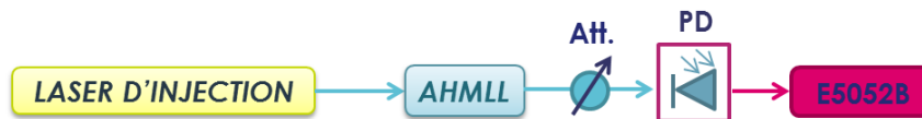
Figure V – 11 Schéma du montage expérimental de la mesure de RIN. AHMLL : laser à verrouillage de modes actif et harmonique. Att. : atténuateur. PD : photodiode.
