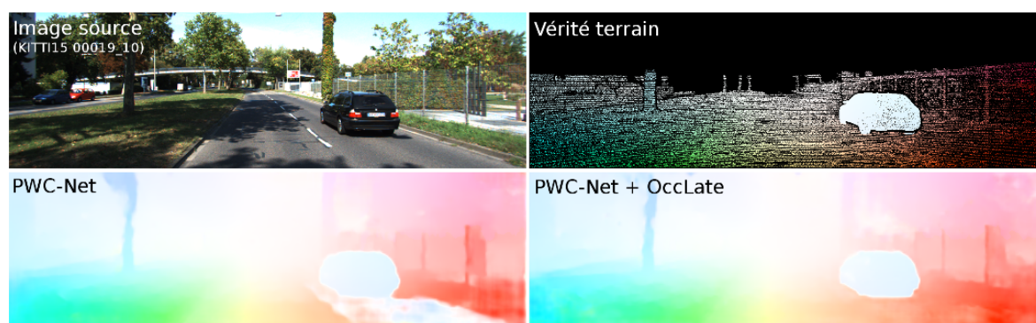
FIGURE 5.5 – Comparaison, pour la 20 e séquence de l'ensemble d'entraînement de KITTI 2015, des flots optiques obtenus avec et sans module d'occultation. L'ajout d'un module d'estimation d'occultations améliore l'estimation de flot optique.
