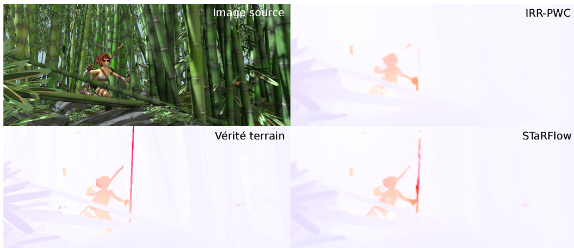
FIGURE 5.18 – Comparaison, pour la 25 e paire d'images de la séquence "Bamboo_2" de Sintel Clean, des flots optiques obtenus IRR-PWC et STaRFlow, entraînés uniquement sur FlyingChairs et FlyingThings3D.
