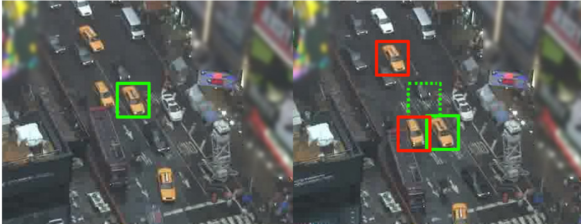
FIGURE 1.7 – Un cas ambigu pour l'estimation de mouvement. Une estimation du flot optique entre les deux images peut présenter des ambiguïtés dans la mesure où plusieurs voitures d'aspects très semblables sont visibles, plusieurs positions donneront donc un score de similarité élevé.
