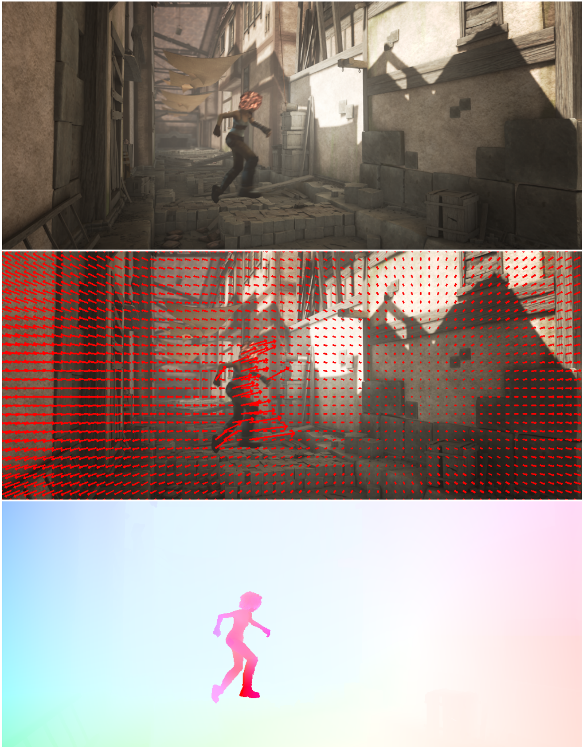
FIGURE 2.6 – Un exemple issu de MPI Sintel, séquence "Alley_2". Image source (en haut) et vérité terrain représentée par des flèches (au milieu) ou dans la représentation colorée décrite en 2.1.1 (en bas).
