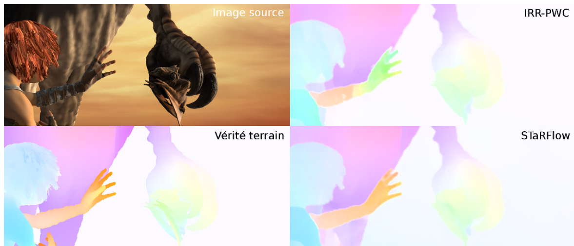
FIGURE 5.16 – Comparaison, pour la 35 e paire d'images de la séquence "Temple_3" de Sintel Clean, des flots optiques obtenus IRR-PWC et STaRFlow, entraînés uniquement sur FlyingChairs et FlyingThings3D.
