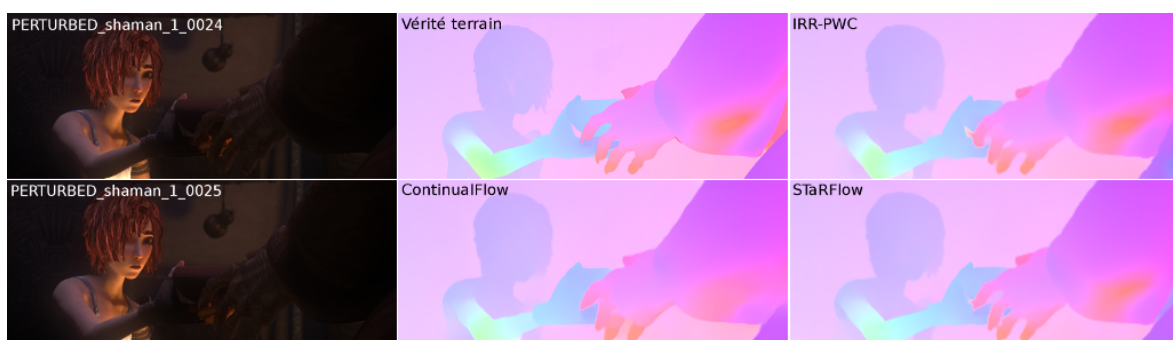
FIGURE 5.15 – Comparaison des flots estimés par IRR-PWC, ContinualFlow et STaRFlow, entre les 24 e et 25 e images de la séquence PERTURBED_shaman_1 de Sintel Test Final. Résultats obtenus sur le site web du benchmark .
