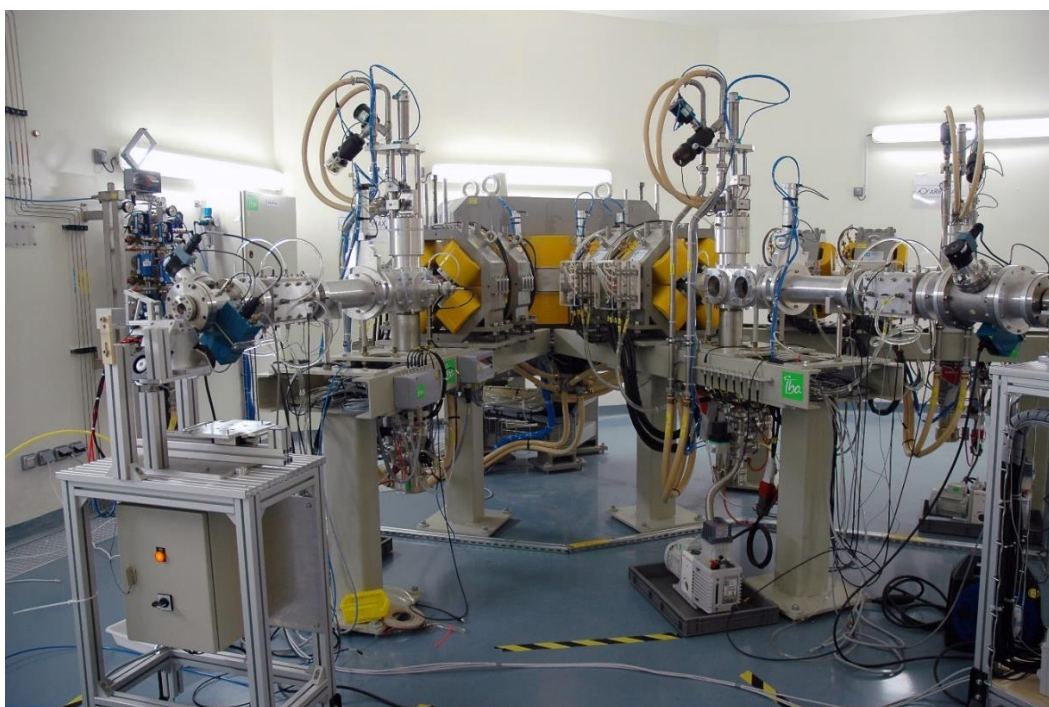
Figure 37 : Casemate de recherche AX au cyclotron ARRONAX. La ligne de faisceau AX4 à droite a été utilisée.
