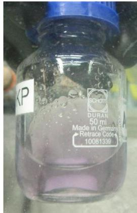
Figure 135 : Photo de la solution d'américium après ajustement de l'acidité (29,8 mL)
