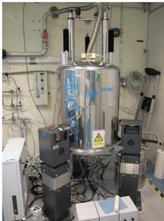
Figure 57 : Spectromètre RMN Agilent DD2 de 400 MHz utilisé.
