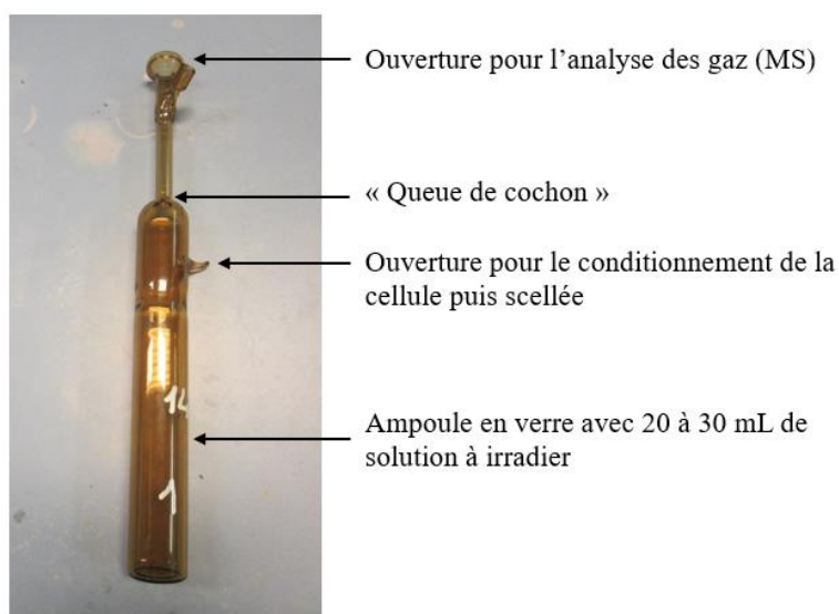
Figure 45 : Ampoule de radiolyse gamma scellée pour l'analyse des gaz de radiolyse.
