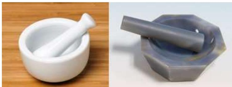
**Figure 1a** (à gauche) : Mortier et pilon en porcelaine ; **Figure 1b** (à droite) : Mortier et pilon en agate.
