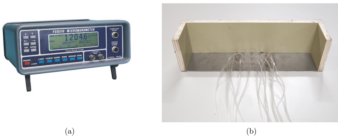
FIGURE 8.5 – a) Micro-manomètre Furness Control FCO510 et b) tuyaux branchés sur les prises de pression.
