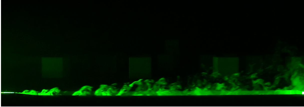
FIGURE 9.15 – U_t/U_{10} = 0.3 et CLA alignée avec le jet - Plan vertical dans l'axe du tunnel.
