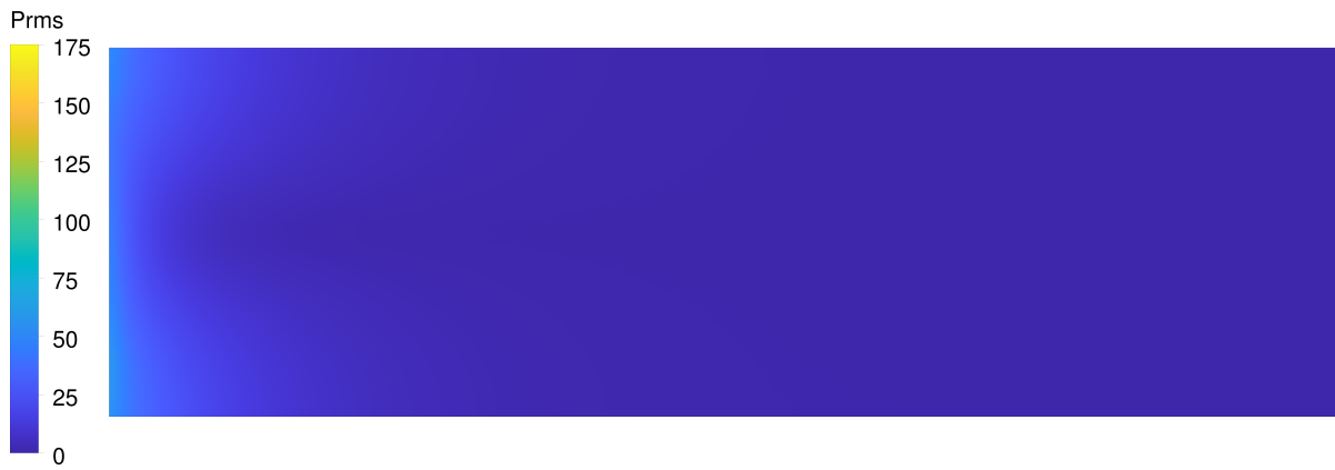
(a) Fluctuations de pression P_{rms} [Pa] du filtre digital.
