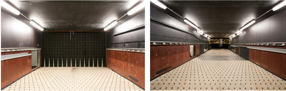
FIGURE 2.4 – Système de déclenchement de la couche limite à l’entrée de la veine d’essai et en amont des maquettes.
