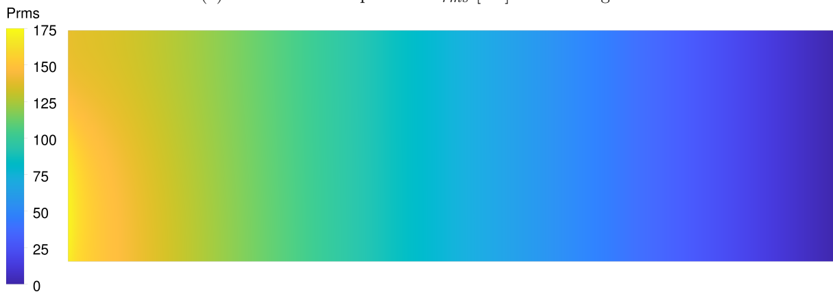
(b) Fluctuations de pression P_{rms} [Pa] de la méthode des vortex.
