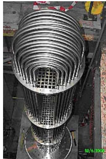
(b) Image du faisceau tubulaire
