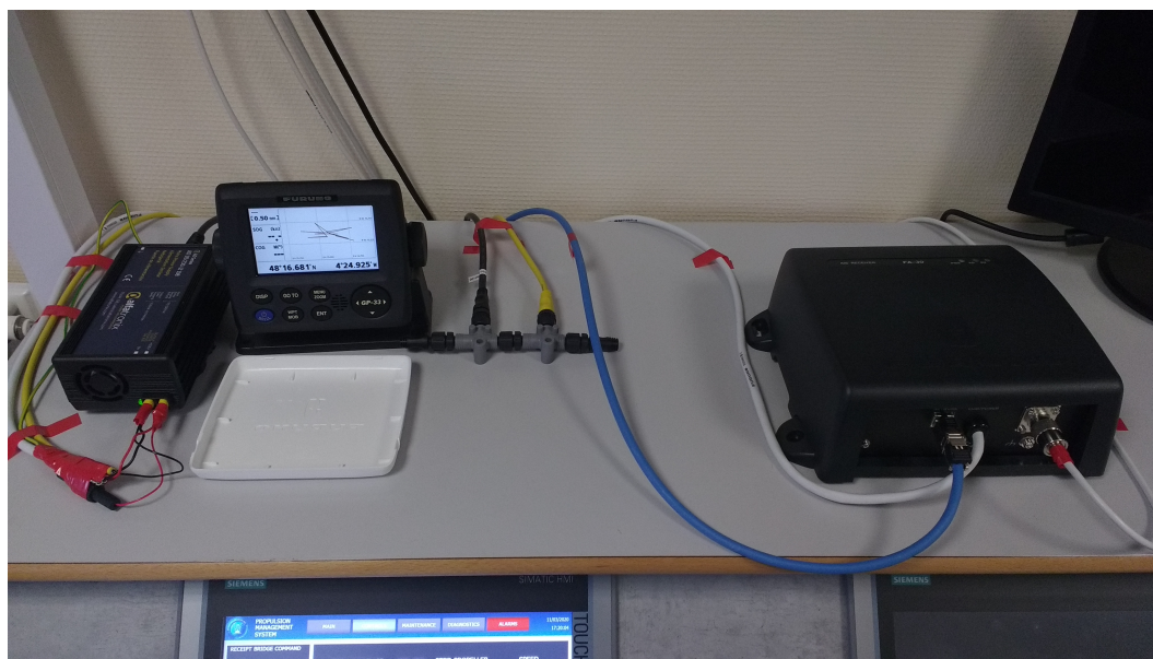
FIGURE IV.3 : Récepteur GPS (à gauche), connecteur NMEA 0183 et bus NMEA 2000 (au centre) et récepteur AIS (à droite) (source : archives personnelles).
