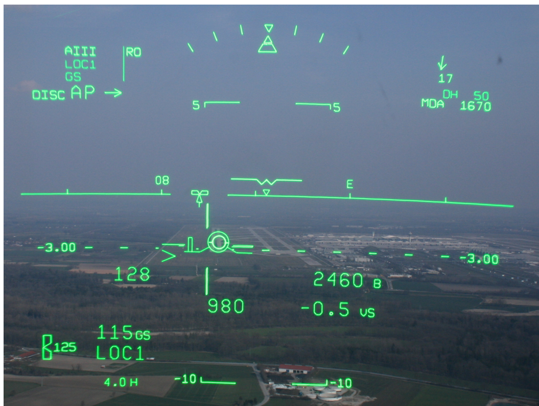
FIGURE III.5 : Collimateur tête haute d'un avion civil Bombardier CRJ-900 en longue finale de l'aéroport de Munich (source : Wikimedia Commons , image non modifiée, auteur : Joschiki, licence : CC BY-SA 3.0 ).
