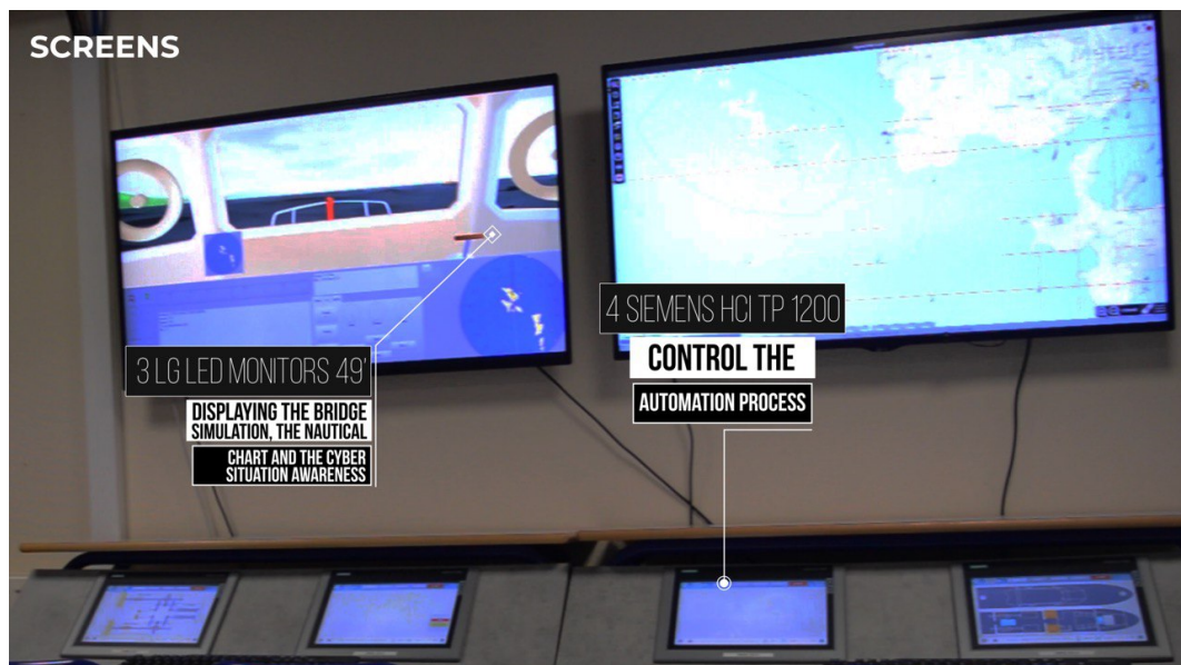
FIGURE IV.2 : Environnement de simulation de la passerelle de navigation (source : Chaire de cybersécurité des systèmes navals , reproduite avec l'aimable autorisation de l'auteur).
