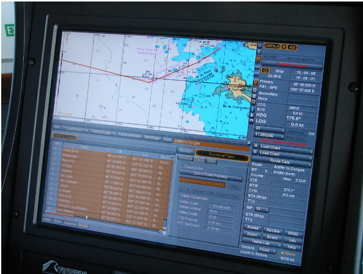
FIGURE III.7 : Exemple d'interface homme/machine d'un ECDIS (source : Wikimedia Commons , image non modifiée, auteur : Hervé Cozanet , licence : CC BY-SA 3.0 ).
