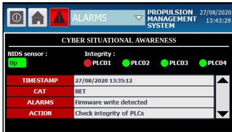
FIGURE IV.37 : Partage d'information et amélioration de la *Maritime Cyber Situational Awareness* par la mise en œuvre d'un panneau de contrôle et d'alerte de l'opérateur d'un système industriel sur le *Naval Cyber Range* (source : archives personnelles).
