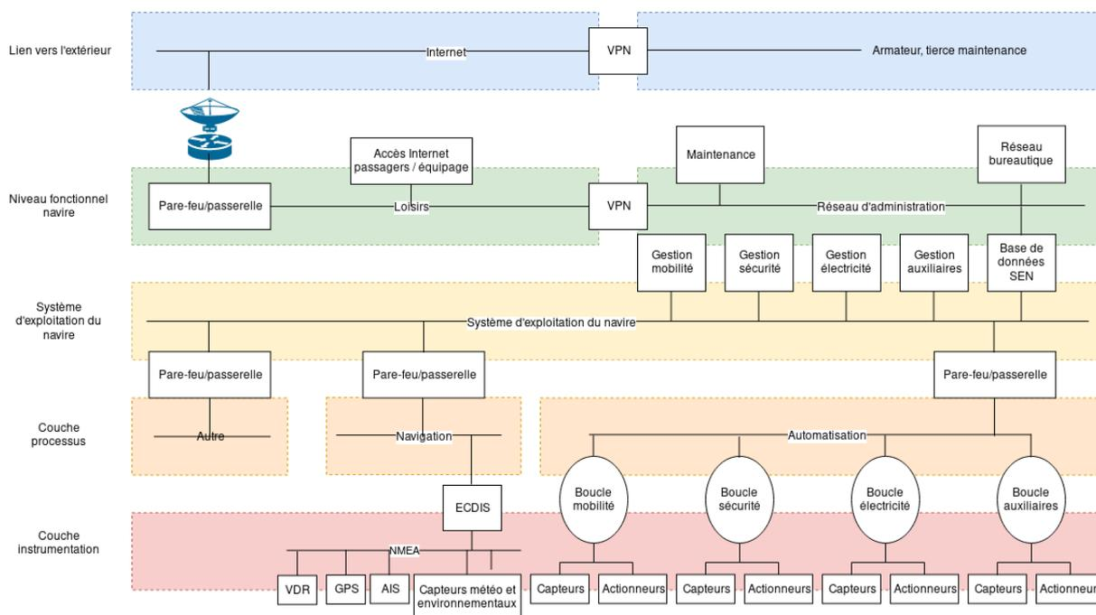
FIGURE IV.5 : Modélisation technique du prototype avec les sous-systèmes « passerelle », « communication » et « industriel » (source : archives personnelles).
