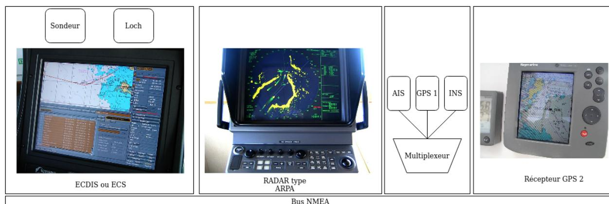
FIGURE IV.36 : Modélisation de l'architecture globale du réseau NMEA à partir des fichiers *cap1*, *cap2* et *cap3* (sources : ECDIS : [Wikimedia Commons](#), image non modifiée, auteur : [Hervé Cozanet](#), licence : [CC BY-SA 3.0](#), RADAR : [Wikimedia Commons](#), image non modifiée, auteur : [Clipper](#), licence : [CC BY-SA 2.5](#), GPS : [Wikimedia Commons](#), image non modifiée, auteur : [Fairley](#), licence : [CC BY-SA 2.0](#)).
