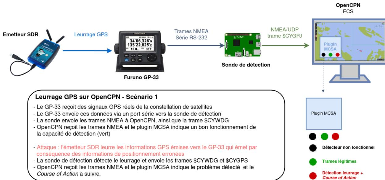
FIGURE IV.39 : Exploitation d'une vulnérabilité extrinsèque du réseau GPS et circuit d'affichage vers l'ECS pour affichage du CoA approprié (source : [Chaire de cyberdéfense des systèmes navals](#), reproduite avec l'aimable autorisation de l'auteur).
