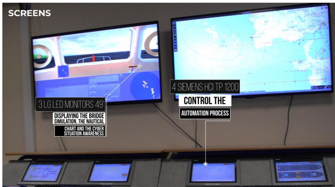
FIGURE IV.2 : Environnement de simulation de la passerelle de navigation (source : [Chaire de cybersécurité des systèmes navals](#), reproduite avec l'aimable autorisation de l'auteur).
