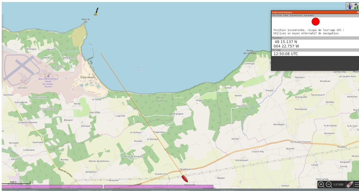
FIGURE IV.41 : Présentation du composant additionnel CARMEN dans l'ECS en présence de leurrage, avec affichage du CoA approprié (source : [Chaire de cyberdéfense des systèmes navals](#), reproduite avec l'aimable autorisation de l'auteur).
