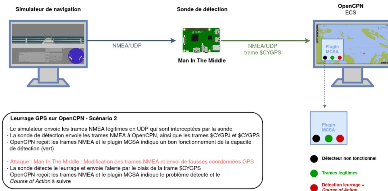
FIGURE IV.38 : Exploitation d'une vulnérabilité intrinsèque du protocole NMEA et circuit d'affichage vers l'ECS pour affichage du CoA approprié (source : [Chaire de cybersécurité des systèmes navals](#), reproduite avec l'aimable autorisation de l'auteur).
