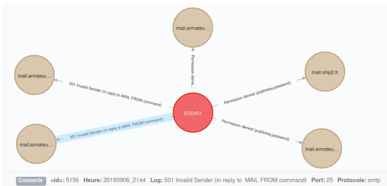
FIGURE IV.28 : Analyse d'un cas de connexions anormales en provenance d'un ECDIS (source : archives personnelles).
