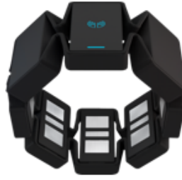
FIGURE 24 – Photo d'un bracelet équipé de plusieurs EMG pour mesurer l'activité musculaire.
