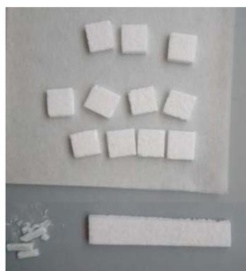
(b) Découpe d'échantillons de  $11 \times 11 \times 3 \text{ mm}^3$  pour le chauffage au laser  $\text{CO}_2$ .
