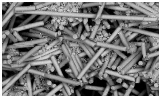
(a) Image MEB d'une céramique à base de fibres de silice [2].
