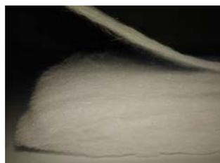
(b) Feutre constitué de plans parallèles dans lesquels les fibres sont orientées aléatoirement.
